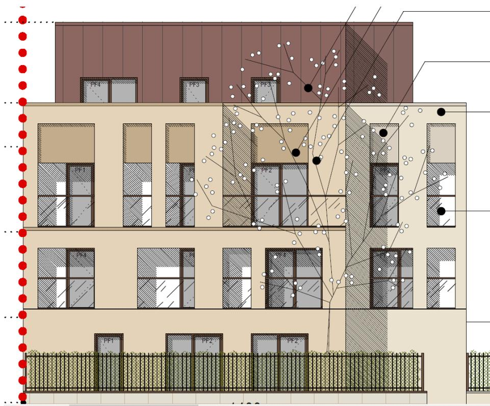
BUGAL ou gamme FERRIA de HORIZONTAL : **Remplissage verre dépoli + lisse haute RAL8025** (Zonage et hauteur suivant façade permis de construire)
